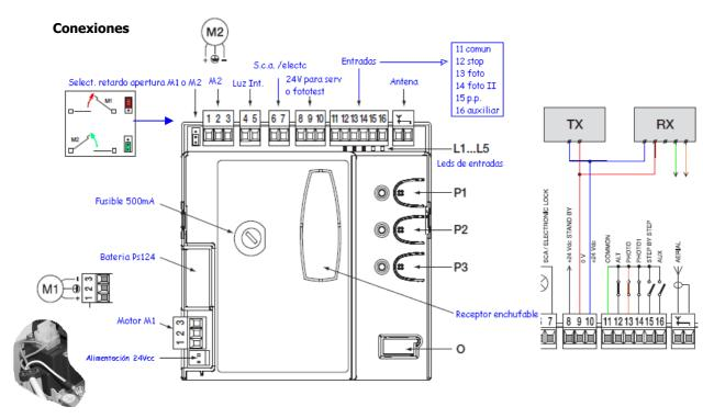
Para comprobar el correcto funcionamiento de los motores, hacer puentes en los contactos normalmente cerrados (stop, entre en 11 y 12 y fotocélulas 11-13-14)
