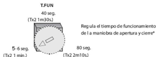
**NOTA:** Cuando (I-4 SW1) está en OFF el potenciómetro T. FUNC actúa como potenciómetro de regulación de fuerza.
